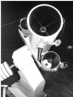
口径40cmF5ニュートン 反射望遠鏡
